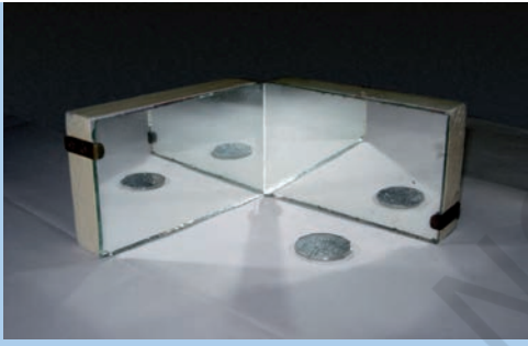
شکل 16.10 : زاویہ قائمہ پر رکھے ہوئے مسطح آئینوں میں شبیہیں دیکھیے اب موم بتی کی کتنی شبیہیں نظر آتی ہیں (شکل 16.11)۔
