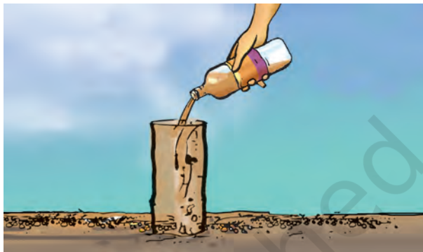
चित्र 9.5 अंतःस्रवण दर को मापना
